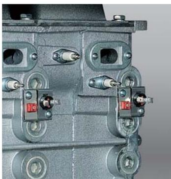
ZÜND- UND ÜBERWACHUNGSELEKTRODEN / SENSOREN
