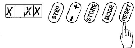
Bei Fehlermeldung 2 - 02 (keine Flamme beim Zünden) ist erst zu überprüfen, ob alle Gasventile geöffnet sind.
