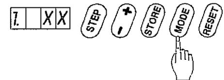
Durch Drücken der Step-Taste (6) den Wert im ersten Fenster auf 2 setzen, der Punkt ist **blinkend**. Die beiden letzten Ziffern zeigen die **Rücklauf-Temperatur** an.
