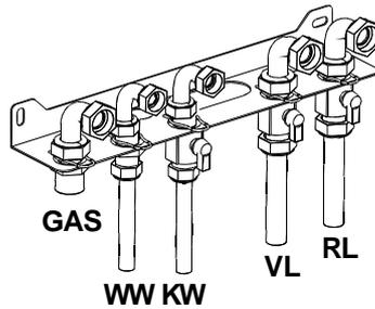
Montageschablone an die tragende Wand befestigen. Dabei einen Mindestabstand für das Kaminfutter berücksichtigen. Montageschiene und Anschlußkonsole mit Hähne positionieren, ausrichten, Löcher bohren und mit beigegebenen Dübel und Schrauben an der Wand befestigen.
