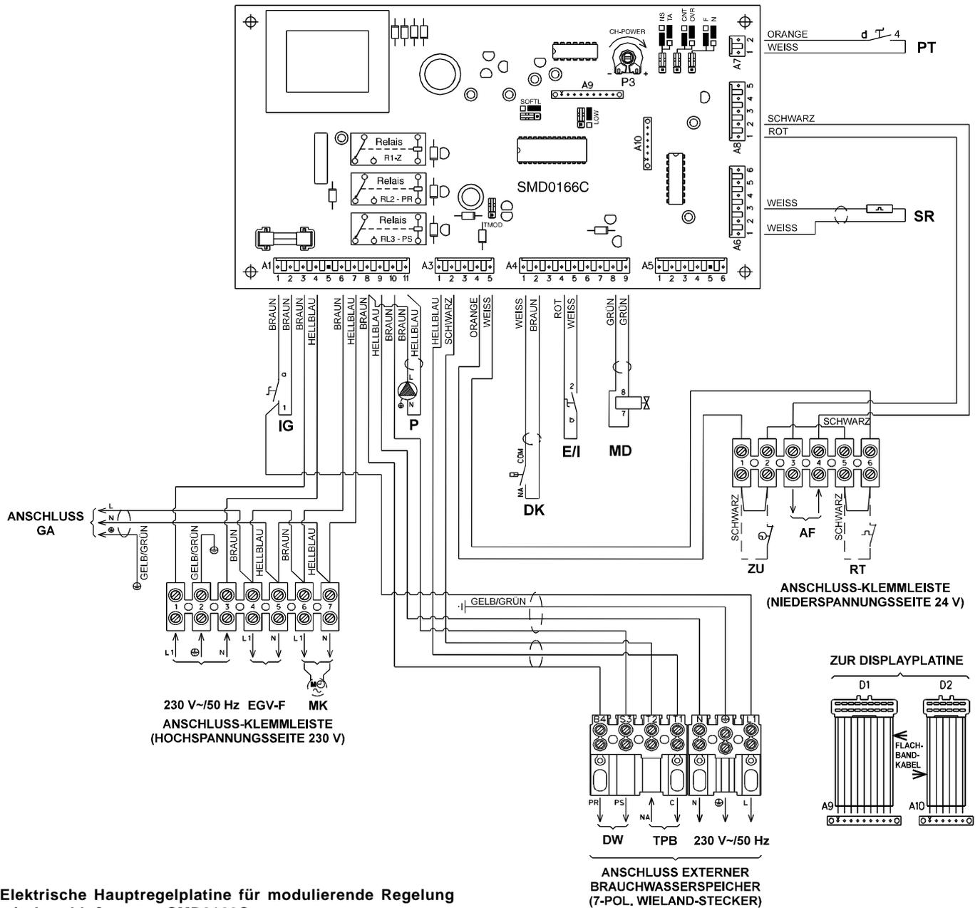
**Elektrische Hauptregelplatte für modulierende Regelung
