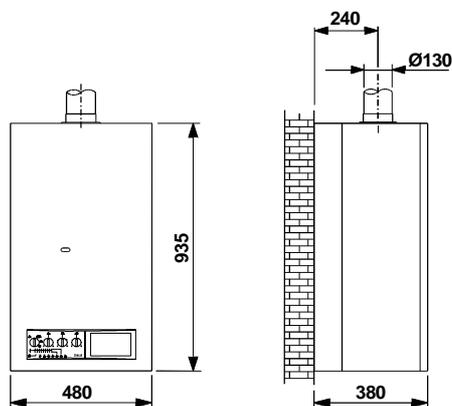
Die Abgasführung ist leicht steigend und auf kürzestem Weg mit dem Schornstein zu verbinden. Scharfe Umlenkungen sind zu vermeiden.
