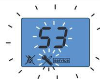
Sollte die Entstörtaste NICHT gedrückt werden, unternimmt der Kessel nach 10 Minuten in jedem Fall einen neuen Zündzyklus-Versuch.
